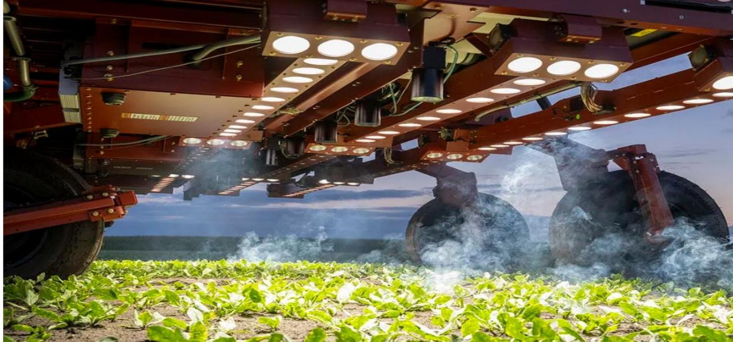
In foto: l'impianto *LaserWeeder* di Carbon Robotics; grazie all'IA il sistema è in grado di utilizzare l'energia termica per eliminare le erbacce senza danneggiare le colture sane o modificare eccessivamente il terreno.
