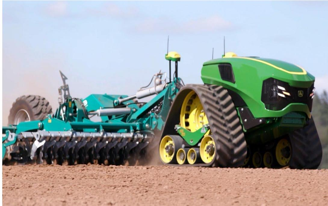
In foto: Il progetto di trattore autonomo di John Deere. Il trattore a guida autonoma avrà una potenza di 500 kilowatt e sarà a zero emissioni
