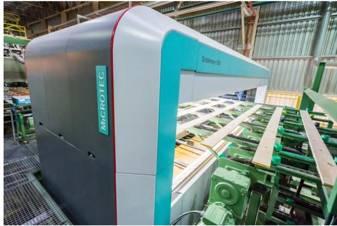
*GoldenEye 900* di MiCROTEC, uno scanner trasversale che determina in maniera precisa la qualità del legname (sia esso fresco, essiccato o piallato) in un solo passaggio da tutti e quattro i lati.
